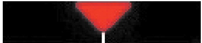
Незавершенный сварной шов, оставляющий зазор на вершине раздела кромок, который стимулирует появление коррозии
